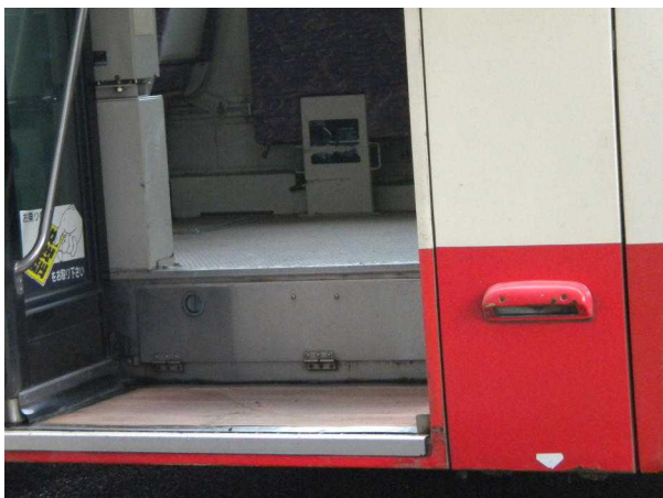
③ここからスロープを出します
