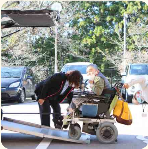
電動車いすの前輪をスロープに乗せ
