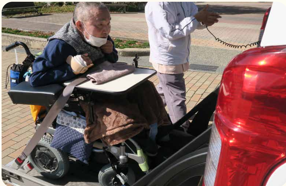
電動車いすをリフターに固定し、上昇させる
