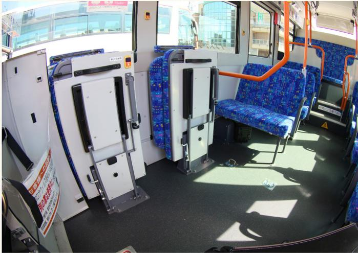
①車いす用の乗車席。このスペースに車いすを専用ベルトで、床に設置された金具に固定。
