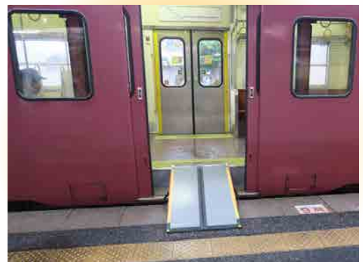
④ 列車にスロープを設置
