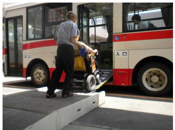
⑤転倒防止に後から支えます
