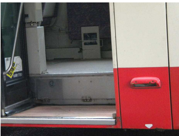
③ここからスロープを出します
